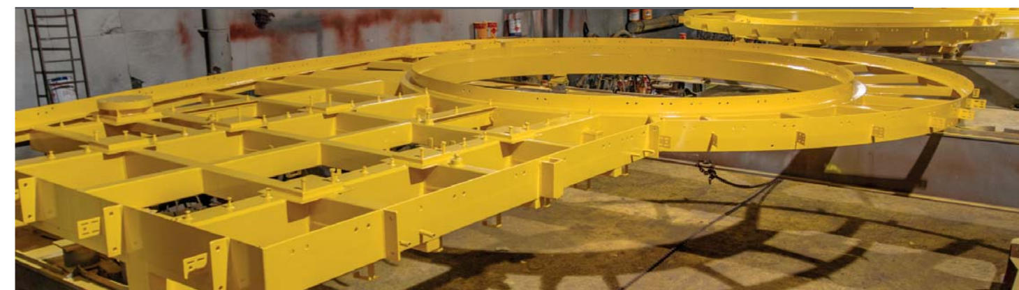
Konstrukcja finalnie pomalowana czterowarstwowym systemem farb firmy Jotun. Aplikacja każdej warstwy wymagała szczególnego nadzoru pod kątem zachowania specyfikowanych grubości i wymagań normy NORSOK m-501.
