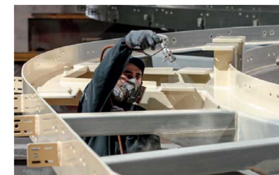
Malowanie hydrodynamiczne wymaga doskonałych umiejętności malarza, by wyeliminować „over spray” (suchy natrysk) czy efekt „orange skin” (pomarańczowej skórki), przy zachowaniu odpowiedniej grubości powłoki.
