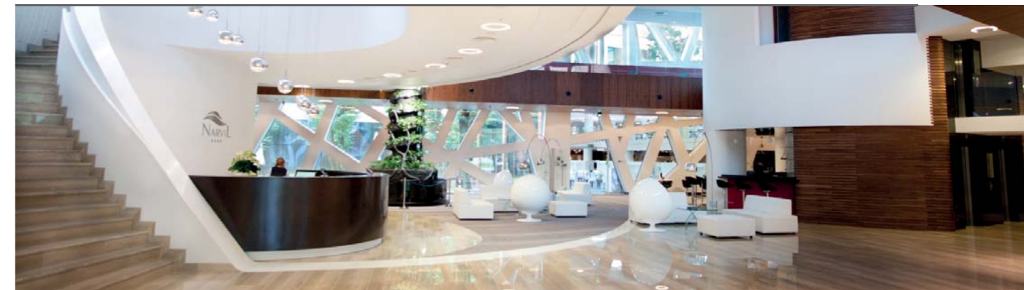
Lobby hotelu z widokiem na recepcję główną oraz bar. Ladę recepcyjną wykonano z materiałów drewnopochodnych z wykorzystaniem konglomeratu typu Staron. Na ścianach lobby użyto okładzin fornirowanych w kolorze orzechowym. Tapicerowane meble wolnostojące pokryto tkaninami trudnopalnymi.
